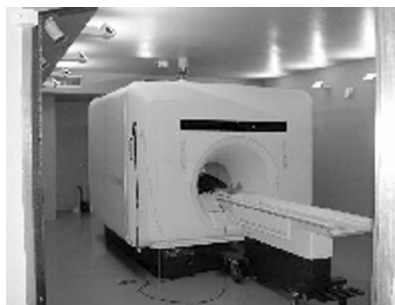
Obr. 3 Scanner MRI se supravodivým magnetem [6]
